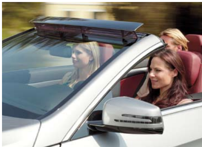
▶ Der per Knopfdruck aus dem Frontscheibenrahmen um sechs Zentimeter ausfahrbare Windabweiser mit Netz hält störende Luftwirbel sogar von den Köpfen der Fondpassagiere fern.
