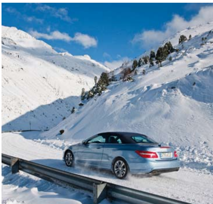
▶ Das strömungsgünstig geformte Akustik-Stoffdach mit großer Glas-Heckscheibe ist geschlossen besonders leise und mit 24 Millimeter Stärke absolut wintertauglich.
