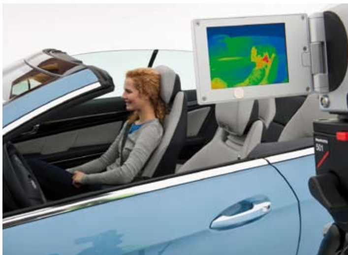
▶ Die Wärmebildkamera macht sichtbar, wie die jetzt schwenkbare Nackenheizung AIRSCARF auch die Beifahrerin unabhängig von ihrer Körpergröße erwärmt.
