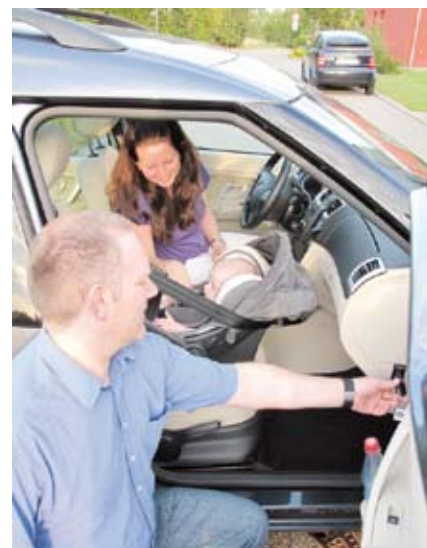
► Der Beifahrer-Airbag ist für die Verwendung eines Reboard-Kindersitzes bequem per Schlüssel abschaltbar.
