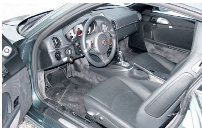
Das neue Sportlenkrad des Cayman hat integrierte Schalttasten für das Doppelkupplungsgetriebe (PDK) und optional eine Lenkradheizung.
