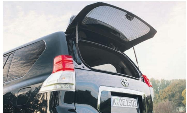
Beim fünftürigen Land Cruiser (mit dem Reserverad unter dem Laderaum) lässt sich das Rückfenster in der großen Heckklappe separat öffnen.
