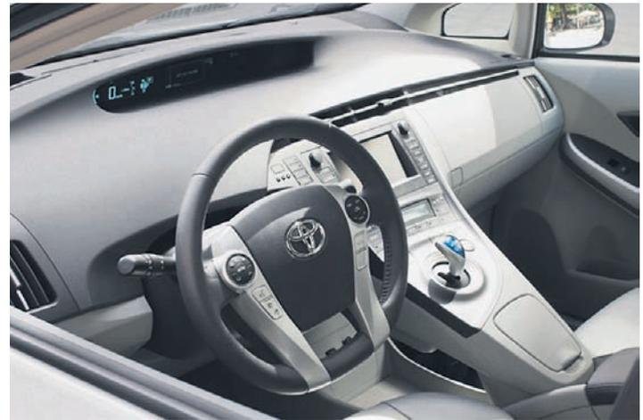
**In zwei Zonen gegliederte Armaturentafel und runde Touch-Tracer-Bedienelemente im Lenkrad heben das Prius-Cockpit aus der Masse heraus.**
