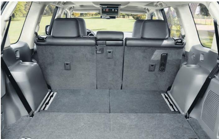
Im glattflächigen Gepäckraum des Land Cruiser kann Ladegut an den seitlichen Schienen im ebenen Boden sicher fixiert werden.
