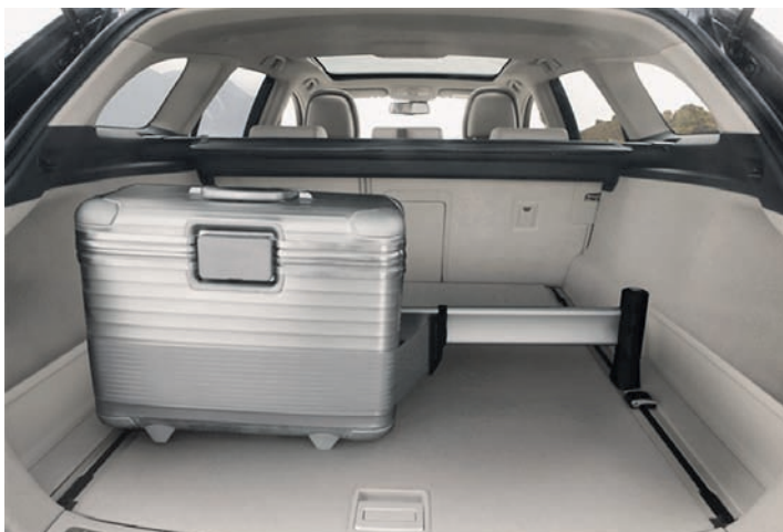
Über die Gepäckschienen lässt sich die Ladung im Heck des Avensis Combi mit der Sonderausstattung „Cargo Manager“ sichern.
