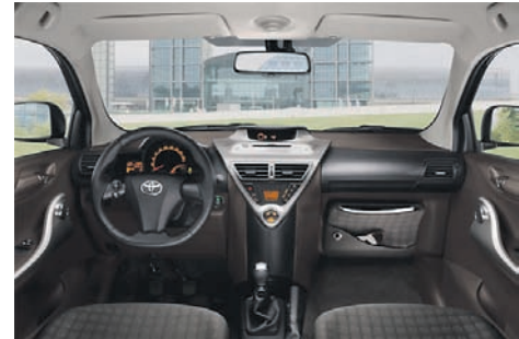
Die raumsparend gestaltete Armaturenanlage des iQ hat statt eines Handschuhfachs rechts die abnehmbare Tasche „iQ Pocket“.
