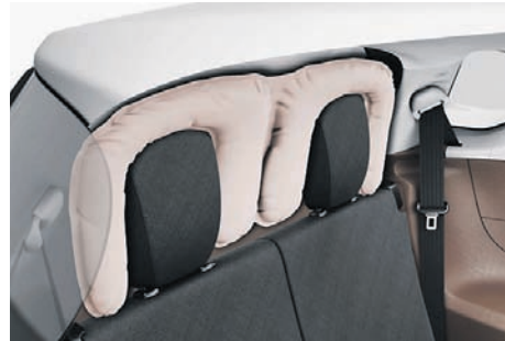
Rund um die Fond-Kopfstützen deckt der Heck-Airbag den ganzen Bereich vor der Rückseite ab.
