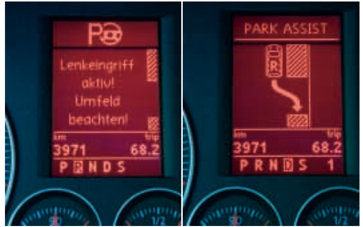
Im Display des Park Assist werden Eignung der Parklücke und „Lenkeingriff aktiv! Umfeld beachten!“ angezeigt.
