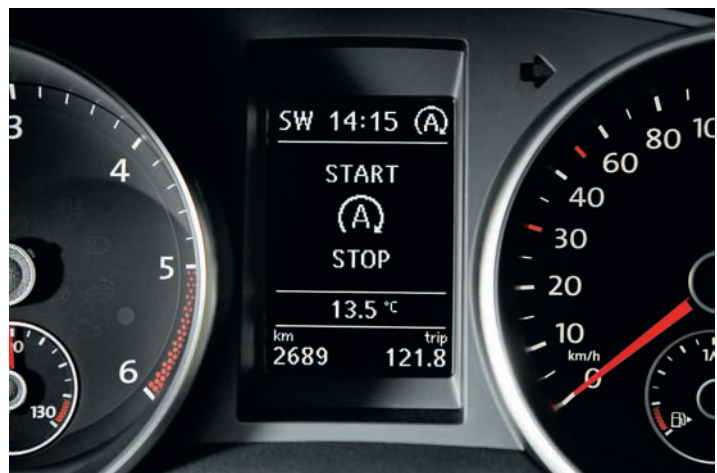
Die Anzeige der Start-Stopp-Automatik (hier im Golf) ist in allen BlueMotion-Modellen gut sichtbar zwischen den Rundinstrumenten platziert.
