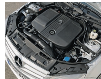
Ein kompaktes Triebwerk mit allen Anbauteilen unter einer Kunststoff-Abdeckung ist der neue Dieselmotor im C 250 CDI.
