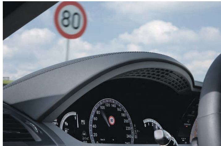
Tempolimit-Schilder werden im Vorbeifahren „gelesen“ und im Kombi-Instrument angezeigt, bis wieder freie Fahrt erlaubt ist.
