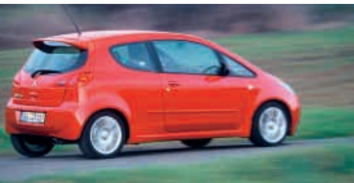
Seitenansicht und in die Heckklappe reichende Rückleuchten unterscheiden den dreitürigen Colt CZT vom Fünftürer.
