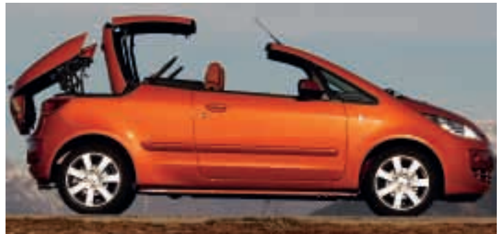
Problemlos faltet sich das zweiteilige Harddach in das kurze Heck des CZC.
