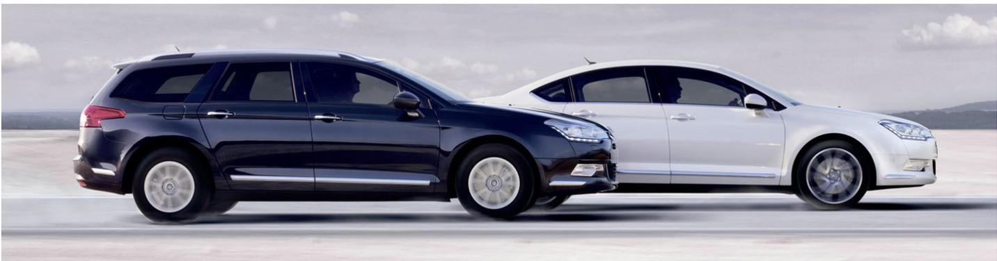
**Bei unverändertem Charakter entsprechen Frontpartie, Fahrwerk und Motorenpalette des C5 Kombi weiterhin der fünftürigen Limousine - angehobene Dachlinie mit langer Dachreling, geräumiges Heck mit niedriger Ladekante und senkrechte Heckleuchten beiderseits der wagenbreiten Heckklappe sind die wesentlichen Unterschiede.**
