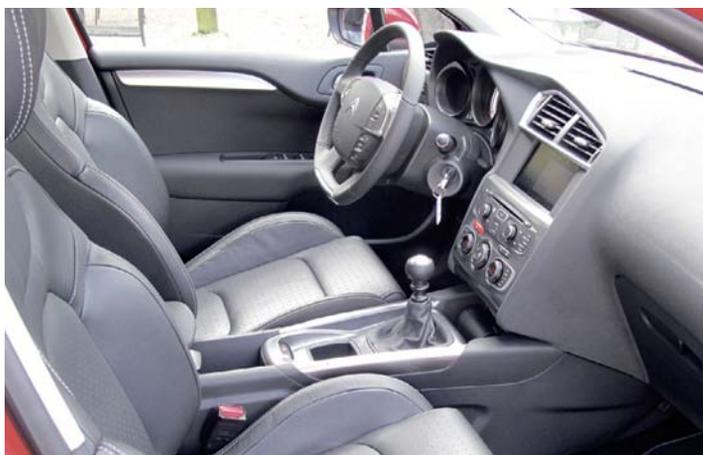
**Im Cockpit des C4 ist das Kombiinstrument exakt im Blickfeld angeordnet und die Bedienelemente im Lenkrad bzw. in der Mittelkonsole liegen gut zur Hand.**
