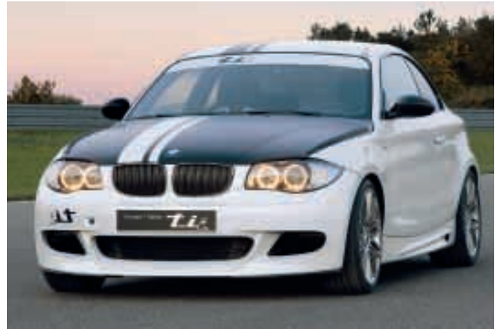
Die dunkle CFK-Motorhaube des Concept 1 Series tii reduziert die Lichtreflexe und fördert damit die Konzentration des Fahrers.
