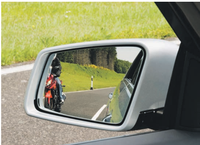
Der Totwinkel-Assistent warnt mit einem roten Dreieck im Außenspiegel und ist zusammen mit dem Spurhalte-Assistent im Spur-Paket enthalten.
