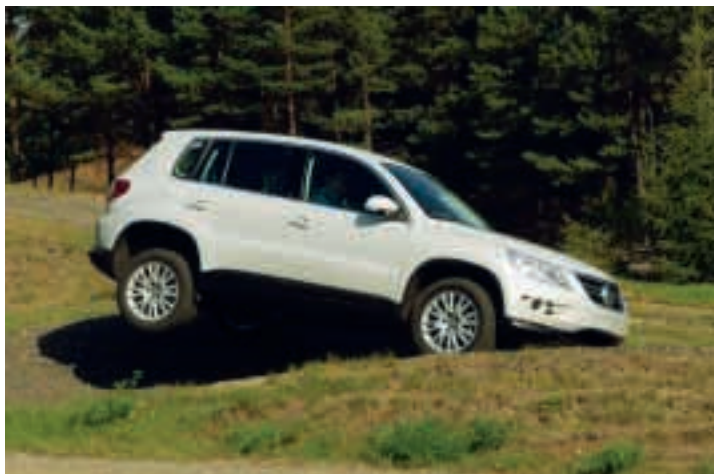
Extreme Böschungswinkel meistert der Tiguan als Track & Field mit der unten abgeschrägten, drei Zentimeter längeren Front.
