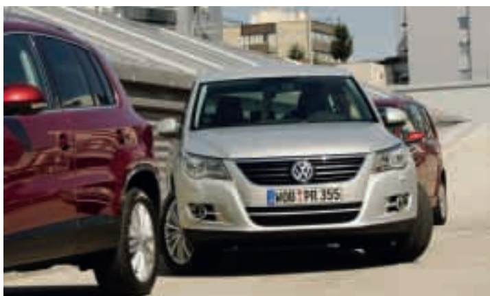
Extreme Böschungswinkel meistert der Tiguan als Track & Field mit der unten abgeschrägten, drei Zentimeter längeren Front.
