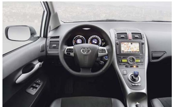
Das Cockpit des Auris-Hybrid kennzeichnen der kleine, blaue Shift-by-wire-Wählhebel und das Kombi-Instrument mit dem „Eco Drive Assist Monitor“
