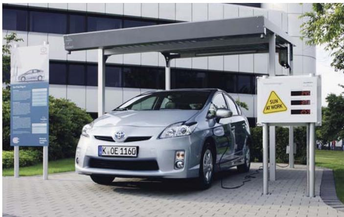
Unter dem Solar-Carport vor der Toyota-Zentrale in Köln-Marsdorf wird der Prius Plug-in aus Photovoltaik-Zellen mit umweltfreundlich erzeugtem Strom geladen
