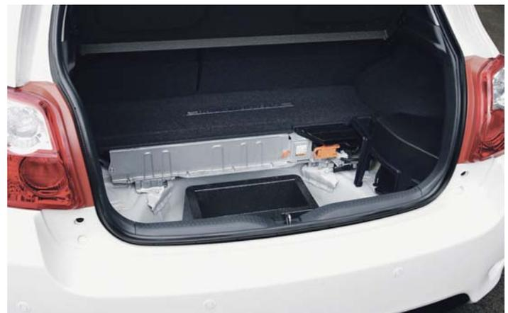
Trotz der großen, über der Hinterachse integrierten Hochleistungsbatterie fasst der Kofferraum des Auris Hybrid über dem Zwischenboden noch 310 Liter
