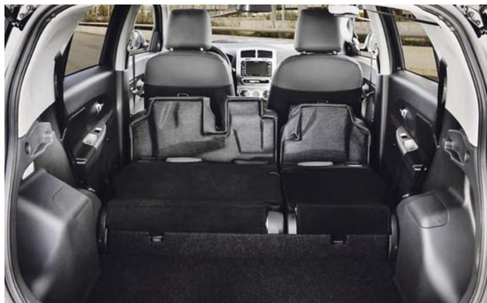
**Bei vorgeklappten Rücksitzen entsteht in der Mitte der genau einen Meter breiten Ladefläche des Urban Cruiser eine deutliche Stufe**
