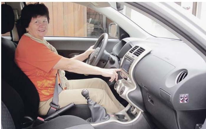
**Bequem ist beim Urban Cruiser zwischen Lenksäule in Mittelkonsole der Start-/Stop-Knopf des optionalen Smart-Key-Systems erreichbar**
