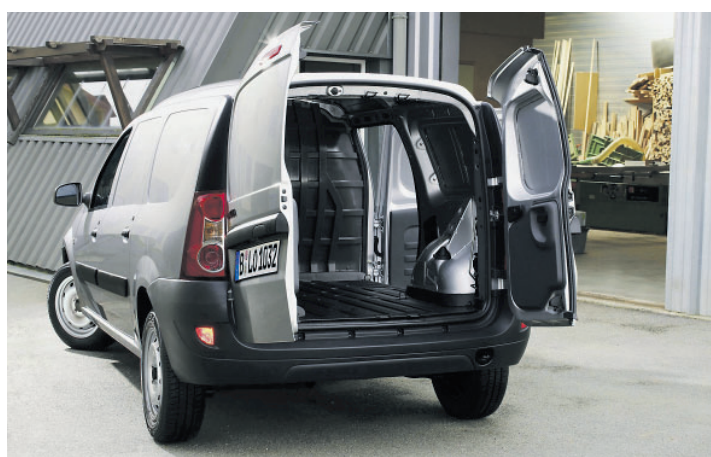
Blechverkleidung statt Verglasung trägt der Logan Van im Heckbereich und unterschiedlich große Türen machen den Laderaum gut zugänglich.
