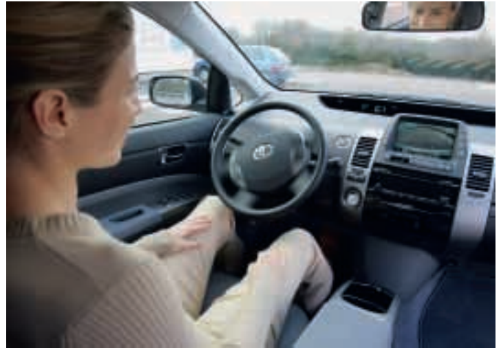
Bei aktivierter Einparkhilfe rollt der Toyota Prius selbsttätig lenkend in die vorgewählte Parkposition.
