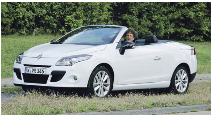
Optimales Gefühl und komfortablen Einstieg sichert beim neuen Mégane Coupé-Cabriolet die zehn Zentimeter nach vorn gerückte Windschutzscheibe
