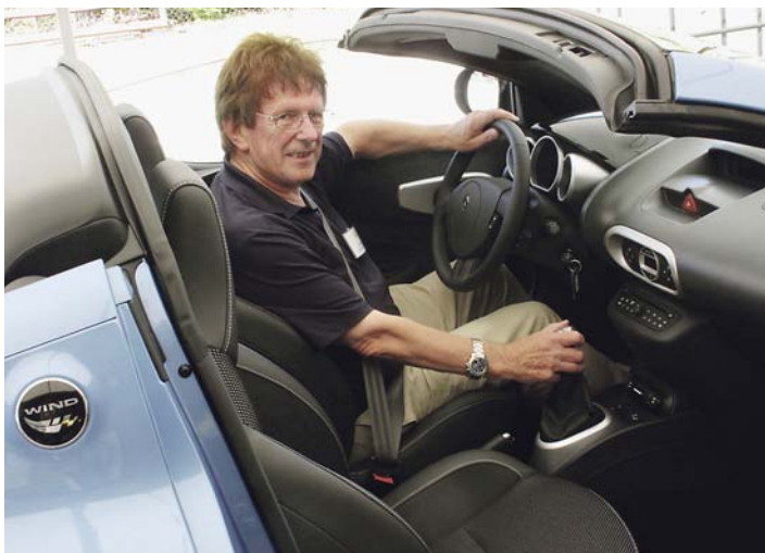
Solider Scheibenrahmen und fester Überrollbügel schützen notfalls im Wind die Insassen auf den neigungsverstellbaren Sportsitzen mit integrierten Kopfstützen
