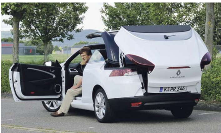
Unter dem schräg nach hinten öffnenden Kofferraumdeckel verschwindet das zweiteilige Panoram-Glasdach des Mégane Coupé-Cabriolets auf Knopfdruck
