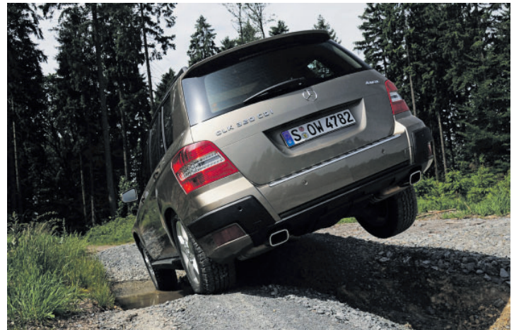
In anspruchsvollem Gelände meistert der GLK Schräglagen bis 35 Grad und Steigungen bis 70 Prozent.
