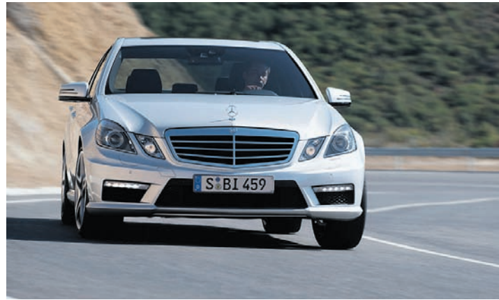
Auf jeder Seite um zwei Zentimeter verbreiterte Kotflügel und das Tagfahrlicht mit LED-Leuchten prägen das dynamische Frontdesign
