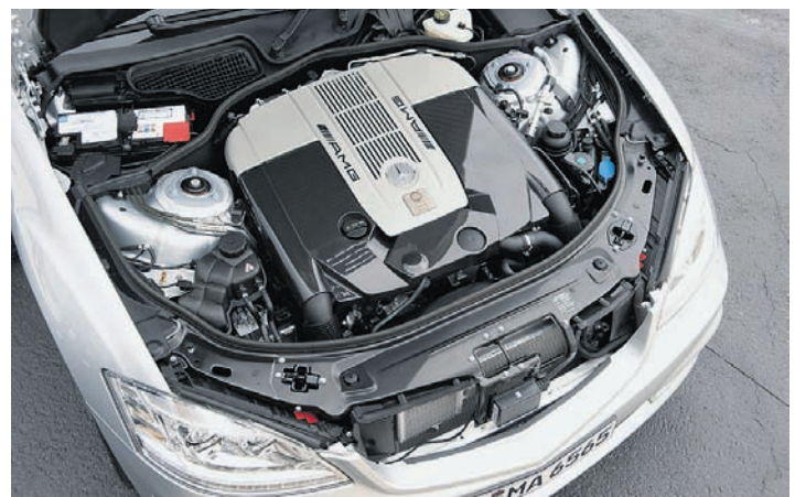
Das maximale Drehmoment des V12-Kraftpakets ist mit Rücksicht auf den Antriebsstrang von 1.200 auf 1.000 Nm reduziert
