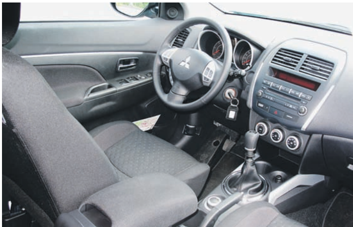
Das ASX-Cockpit prägen Instrumente mit Schirmkappen, chromumrandete Schaltkonsole und Seitenwandverkleidung in Zweitton-Oberflächenstruktur.
