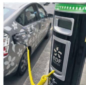
byshire investiert. Den unbestreitbaren Entwicklungsvorsprung bei der Voll-Hybrid-Technologie will Toyota im kommenden Jahr außerdem beim Prius weiter ausbauen. Die ersten 500 Plug-In-Modelle erhalten neben der auf ein Auto-Leben ausgelegten Nickel-Metallhydrid-Batterie einen Lithium-Ionen-Speicher. Dieser soll in 1,5 Stunden an jeder 220 Volt-Haushaltssteckdose aufladbar sein und bis zu 30 Kilometer „elektrische“ Reichweite bringen.
