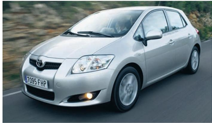
Der fünfsitzige Auris ist auch als HV mit 4,22 Meter Länge und 1,76 Meter Breite „typisch Kompaktklasse“, seine 1,52 Meter Höhe ragen aber darüber hinaus.
