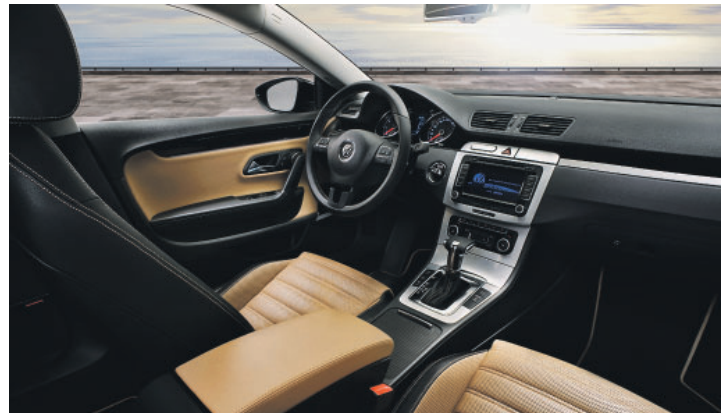
Auf den Screen im Cockpit des Passat CC kann mit der Einparkunterstützung „Rear Assist“ das Bild der Heckkamera (im VW-Emblem) übertragen werden.
