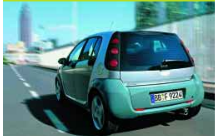
Räumlich ausgearbeitete runde Heckleuchten sind zwischen C-Säule und Rückfenster einzeln übereinander angeordnet.
