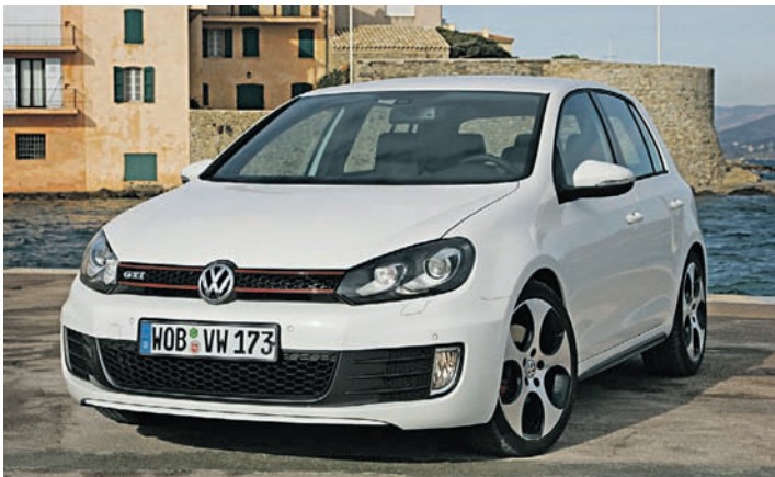
GTI-typisch sind spezifischer Kühlergrill, zusätzliche Lufteintrittsöffnungen im Frontspoiler, lackierte Stoßfänger und vertikale Nebelscheinwerfer.
