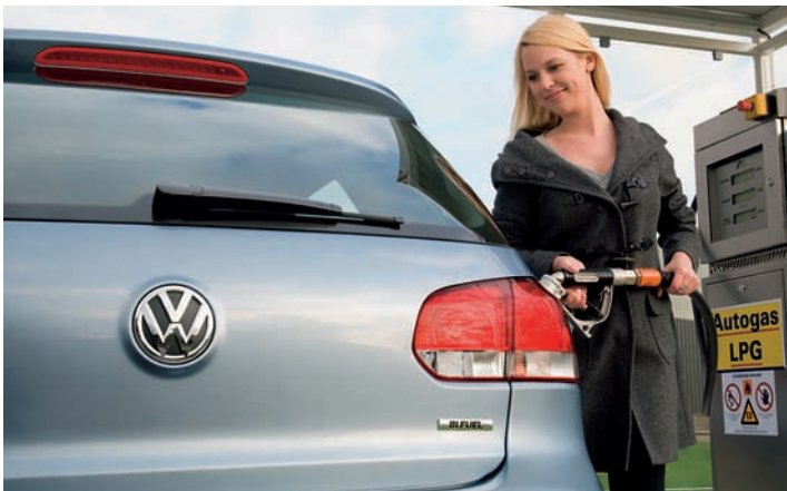
Leicht mit Liquid Petrol Gas LPG oder „Autogas“ zu betanken ist der Golf BiFuel über den Anschluss unter der serienmäßigen Tankklappe.
