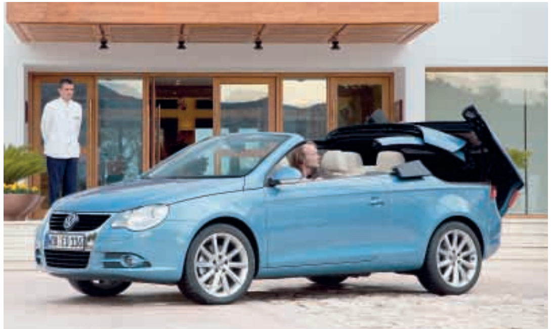
In 30 Sekunden völlig versenkbar ist beim Eos das fünfteilige Harddach mit integriertem Glasteil.
