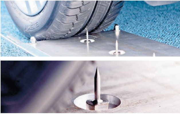
Der Michelin Pneu mit dem „3-S-Konzept“ rollt über mehrere Zentimeter lange Stahlnägel, ohne dass der geringste Druckverlust entsteht. Eine spezielle Gummimischung im Reifeninnern versiegelt von selbst sofort die Löcher in der Lauffläche.
