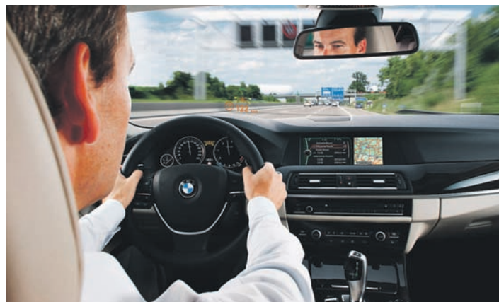
Das optionale Headup-Display projiziert im neuen BMW 5er neben dem aktuellen Tempo auch die zuletzt erkannte Geschwindigkeitsbegrenzung in die Frontscheibe.
