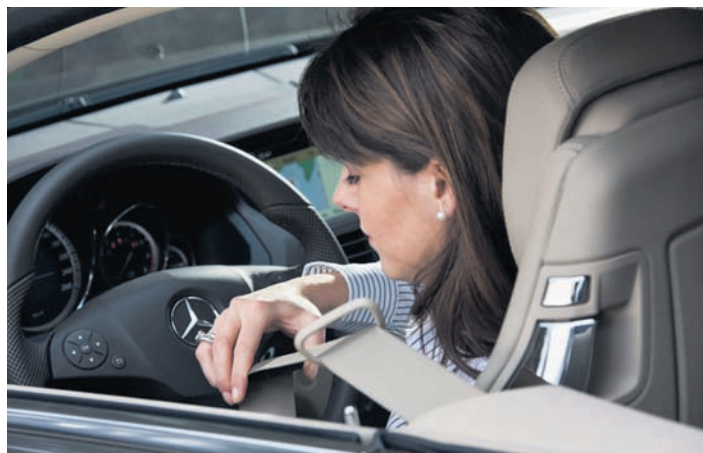
Der hilfreiche Gurtbringer gehört traditionell zum Coupé der E-Klasse und lässt sich nach dem Einsteigen auch ein zweites Mal ausfahren.
