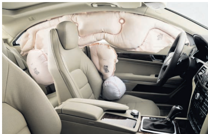
Insgesamt sieben Airbags und integrierte Kopfstützen schützen die Insassen auf den vier vollwertigen Plätzen des Coupés der E-Klasse.
