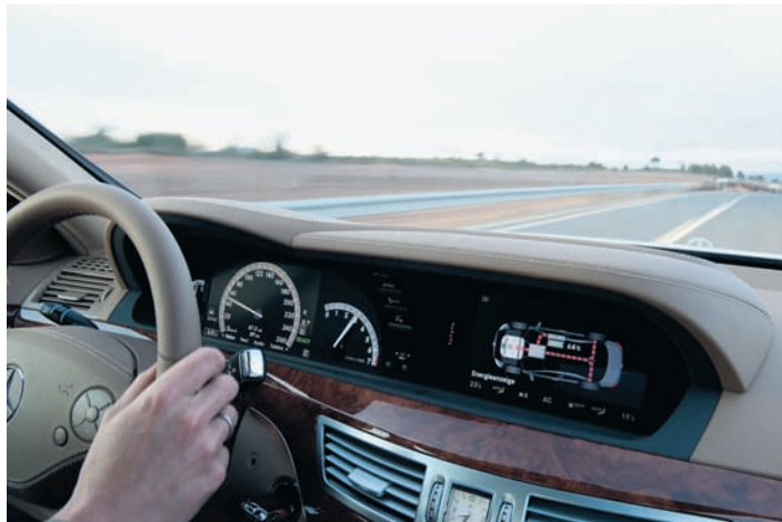
Mit der Energieanzeige werden der Kraftfluss im Hybrid-System und der Ladezustand der Lithium-Ionen-Batterie übersichtlich dargestellt.
