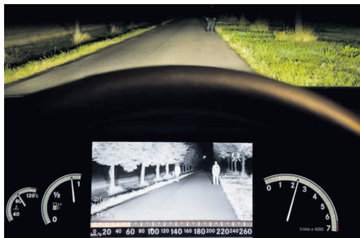
Der Nachtsicht-Assistent Plus nutzt Infrarot-Scheinwerfer für eine Graustufen-Darstellung von Fußgängern auf dem Display in der Instrumententafel.
