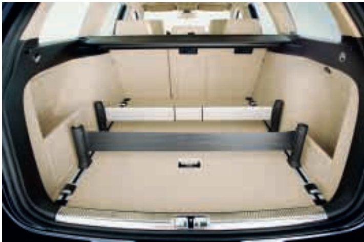
Gepäckmanagement-Paket aus Spanngurt und Teleskopschiene oder direkt mit dem Stoßfänger verbundenes Fahrradträgersystem erleichtern und sichern den Transport sperriger Güter im oder am Passat Variant.
