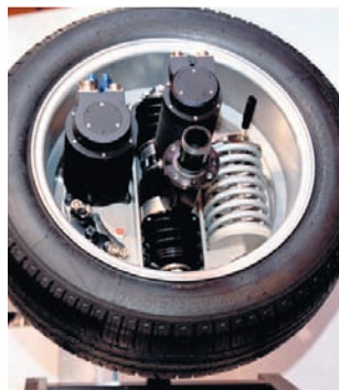
Zukunftsweisend sind elektrischer Antrieb, Federung und Bremse in einem Auto-Rad untergebracht.
