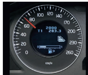
Im Tachometer zeigt Driver Alert zuerst den Konzentrationsgrad mit Balken-Symbolen und warnt dann bei Übermüdung mit einer Kaffeetasse.
