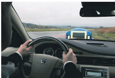
Bei drohendem Aufprall wird in die Frontscheibe ein rotes Warnsymbol projiziert und ein akustisches Signal ertönt.
