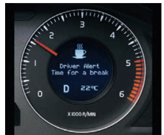
Im Tachometer zeigt Driver Alert zuerst den Konzentrationsgrad mit Balken-Symbolen und warnt dann bei Übermüdung mit einer Kaffeetasse.
