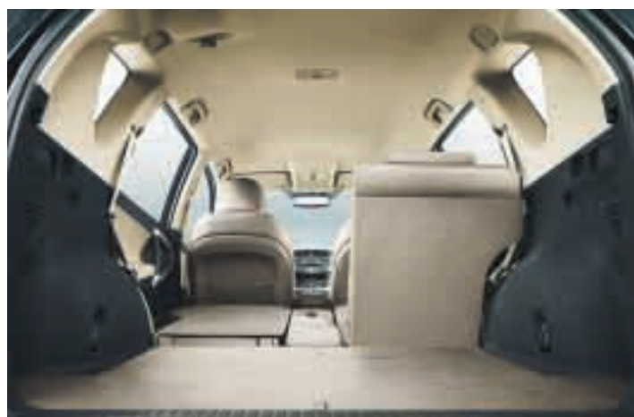
Eine fast ebene Ladefläche entsteht im RAV4 durch Umklappen der dreigeteilten Rückbank.
