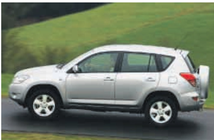
Alle RAV4 – außer der Top-Version – tragen das Reserverad auf der rechts angeschlagenen Hecktür.
