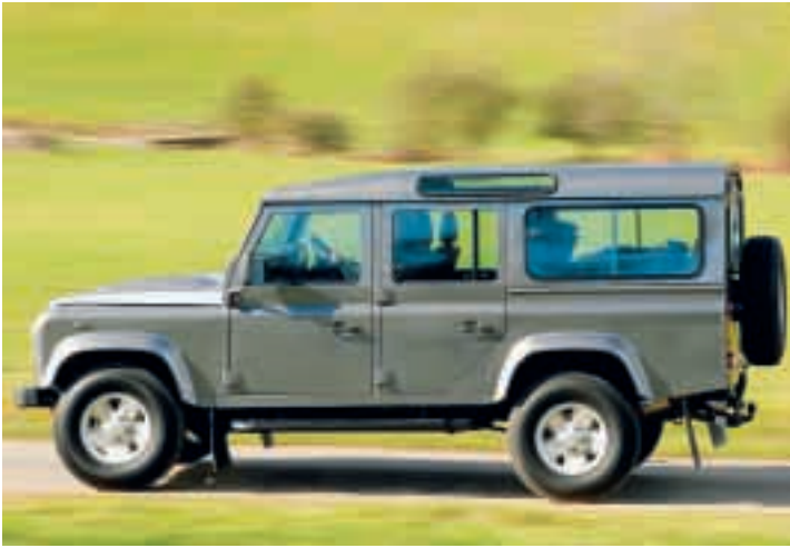
Extrem verschränkbare Starrachsen sichern dem Defender beste Geländegängigkeit.
