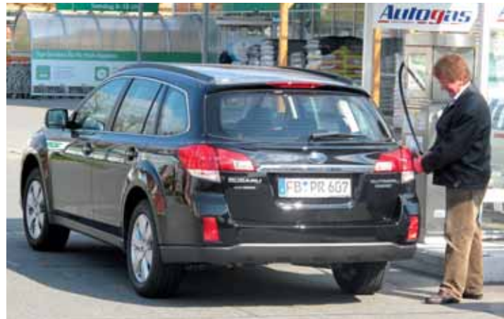
Der Adapter für die Autogas-Zapfpistole wird beim Outback bequem über dem normalen Tankverschluss (nur handfest!) eingeschraubt.
