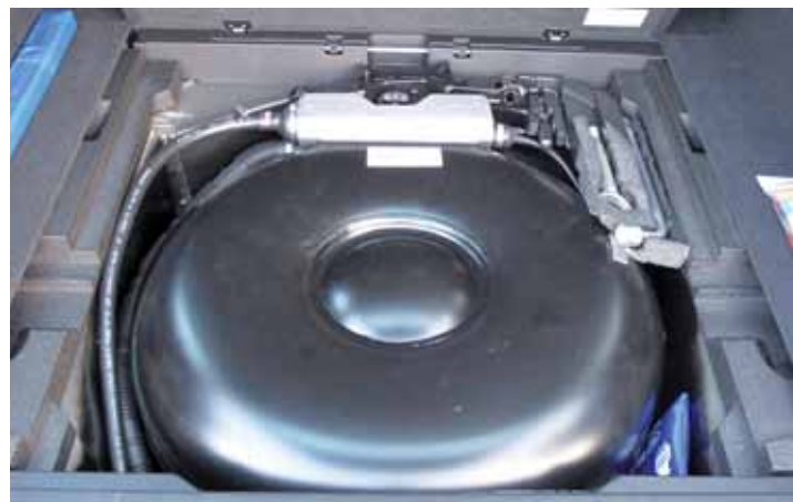
Der Autogas-Tank passt genau in die Mulde für das normale Reserverad und stattdessen gibt es zum Reifen-Reparaturset einen kleinen Kompressor.
