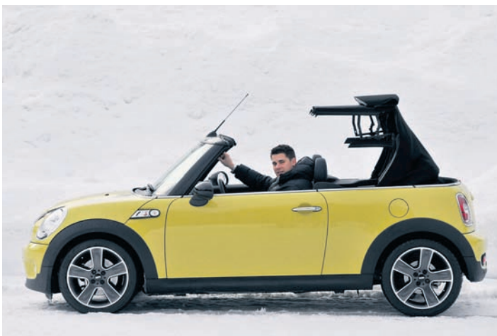
Auf Knopfdruck öffnet oder schließt sich das vollständig ins kurze Heck passende Stoffverdeck beim MINI Cabrio.
