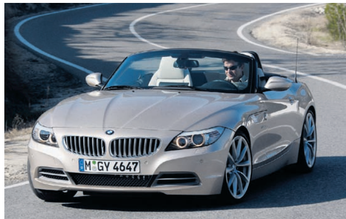
Die aufgelegte Motorhaube des Z4 ist die größte im gesamten BMW-Modellprogramm und reicht seitlich bis zu den Radausschnitten.
