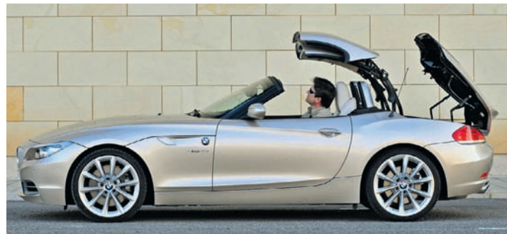
Das Heckteil des Z4-Hardtops schiebt sich über den vorderen Dachteil und beides passt platzsparend unter den nach hinten aufschwingenden Heckdeckel.
