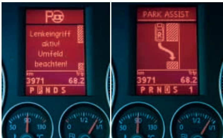
Im Display des Park Assist werden Eignung der Parklücke und „Lenkeingriff aktiv! Umfeld beachten!“ angezeigt.
