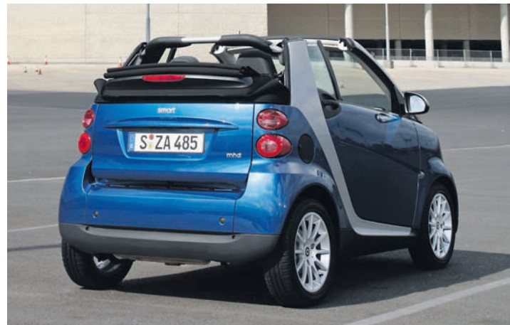
Auch bei zurückgeklapptem Faltdach bleibt beim smart fortwo Cabrio die dritte Bremsleuchte an der Dachkante sichtbar.
