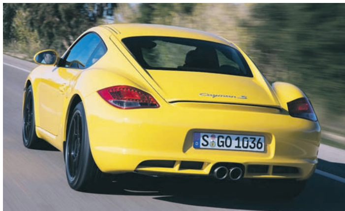
Beim Cayman reicht die Heckklappe bis zwischen die Rückleuchten herunter und trägt auch den automatisch ausfahrenden Spoiler.
