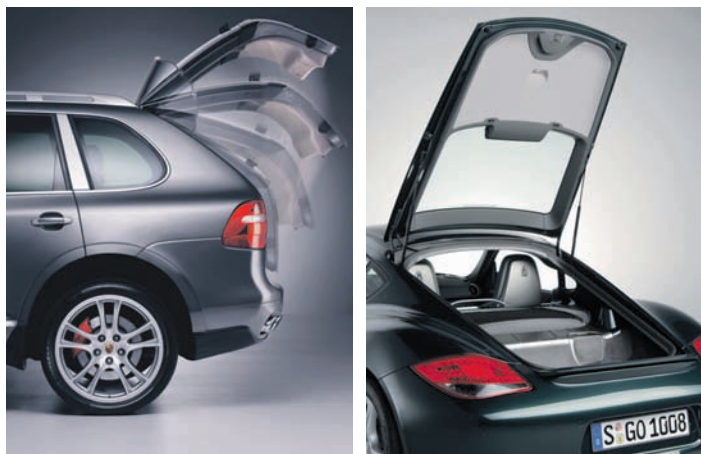
Während sich die Heckklappe beim Cayenne auf Wunsch elektrisch bewegt, muss sie beim Cayman stets von Hand geöffnet und geschlossen werden.
