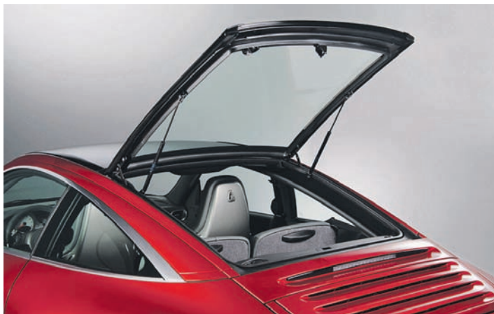
Das hintere Segment des Glasdaches ist beim Targa 4 die elektrisch beheizbare Heckklappe, die es bei den anderen Karosserievarianten des Elfers nicht gibt.
