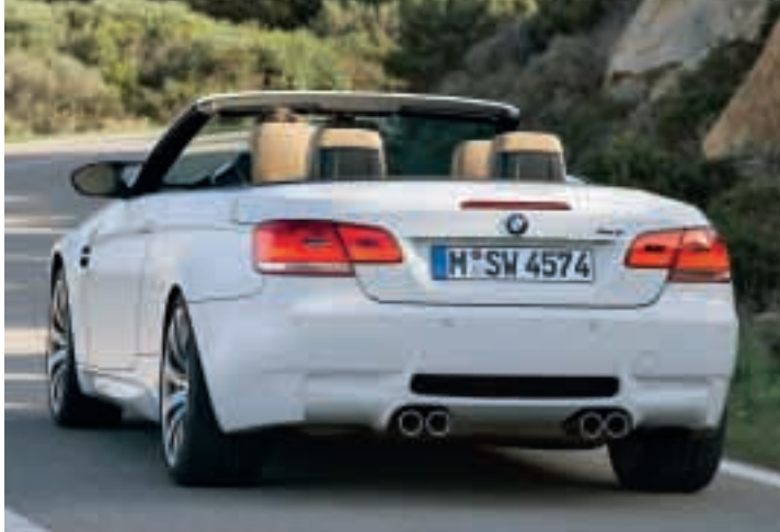
Vier Auspuff-Endrohre und Diffusor im Stoßfänger weisen beim M3 Cabrio auf die exklusive Sportversion hin.
