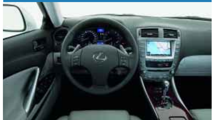
Informationsdisplay, Geschwindigkeitsregelanlage, Telefon und Audiosystem werden vom Lenkrad aus gesteuert.
