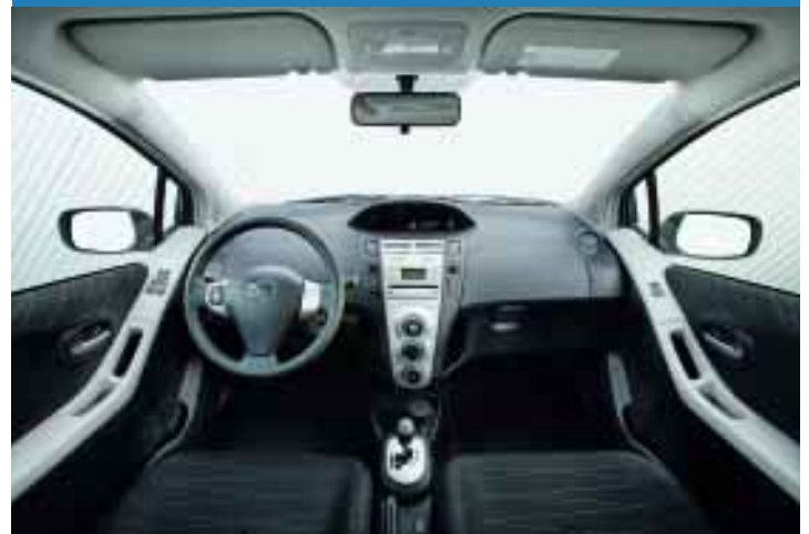
Auf einen Blick erfassbar ist das im Yaris über der Mittelkonsole zentral angeordnete Tiefendisplay.
