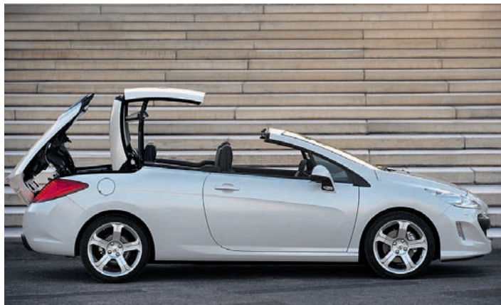
Obwohl ein echter Viersitzer, reicht dem neuen 308 CC eine zweiteilige und entsprechend unempfindliche Faltdach-Konstruktion.
