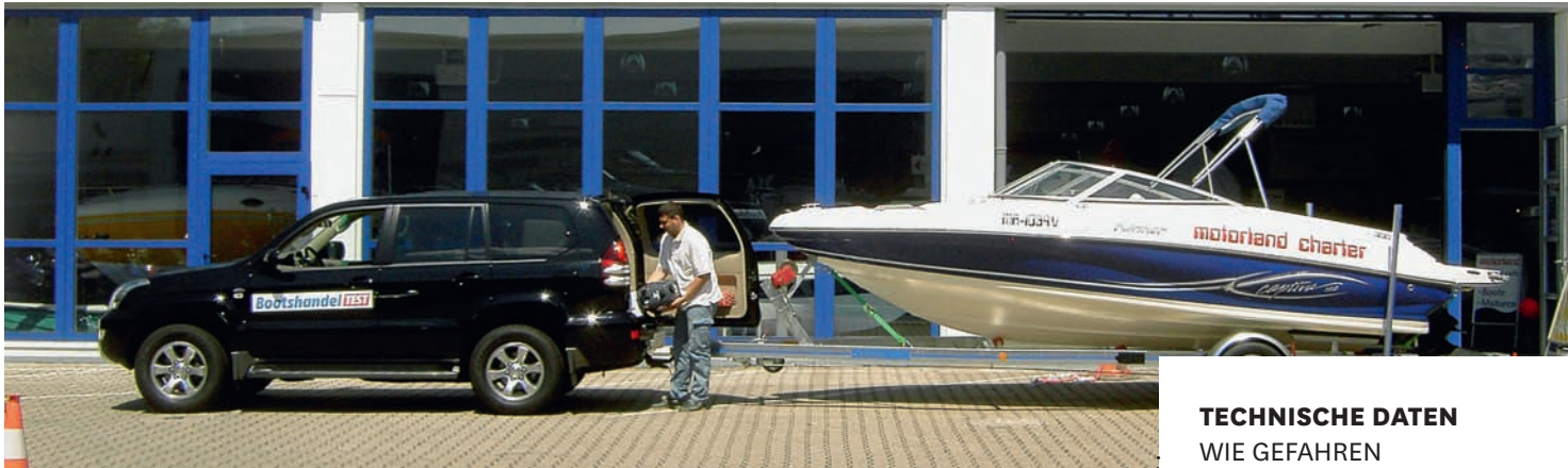
Bei der Executive-Ausstattung liegt das Reserverad unterm Heck, was den Öffnungswinkel der Hecktür bei Trailerbetrieb vergrößert
