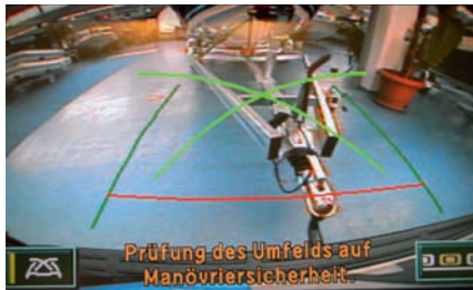
Per Rückfahrkamera lässt sich der Kugelkopf ohne Einweiser exakt unter die Anhängerkupplung rangieren
