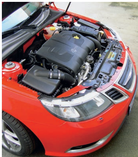
Sauber eingepasst verbirgt sich der quer eingebaute Dieselmotor unter einer großen Kunststoff-Abdeckung
